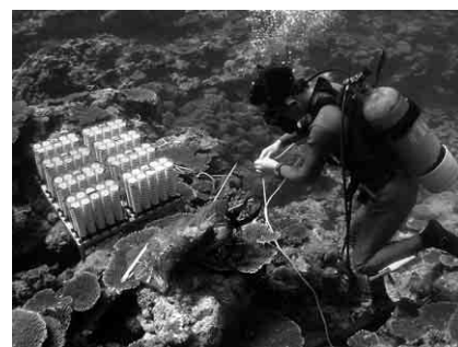
写真4 サンゴ着床具を搭載したフレームの設置
